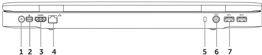
**1 Σύνδεσμος εισόδου κεραίας (σε υποστηριζόμενα μοντέλα)** — Συνδέει εξωτερική κεραία (περιλαμβάνεται στη συσκευασία) ή ομοαξονικό καλώδιο (με προσαρμογέα που περιλαμβάνεται στη συσκευασία) για να μπορείτε να δείτε προγράμματα χρησιμοποιώντας την (προαιρετική) κάρτα δέκτη τηλεόρασης.
